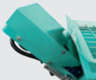
Sensore di sicurezza griglia bifunzionale con segnalazione luminosa. Agisce quando si rimuove la griglia tramoggia e quando si apre il motore della camera di miscelazione. Semplifica le operazioni di pulizia garantendo il massimo della sicurezza.
