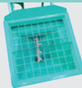
Tramoggia ad alimentazione per caduta capacità 50 l estensibile a 70 l, con l'apposito accessorio "estensione tramoggia". Consigliato per la lavorazione di prodotti alleggeriti, sempre contenuti in sacchi voluminosi, o per prodotti autolivellanti dove le portate di materiale sono elevate.
